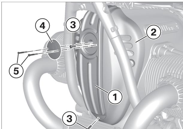
► **Zierleiste für Motorgehäusedeckel einbauen**
