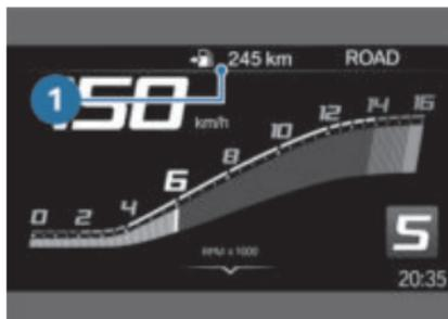
Die Reichweite **1** gibt an, welche Strecke mit dem verbleibenden Kraftstoff noch gefahren werden kann. Die Berechnung erfolgt anhand des Durchschnittsverbrauchs und der Kraftstoffmenge.
