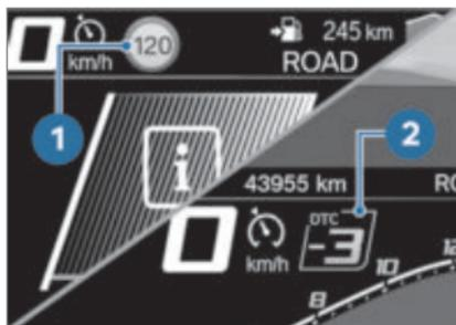
Ist Fahrmodus RACE PRO aktiviert, wird Speed Limit Info **1** ausgeblendet und stattdessen der DTC-Regelwert **2** angezeigt.
