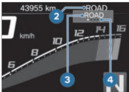
Der aktive Fahrmodus **2** rückt in den Hintergrund und wird im Pop-up **3** angezeigt. Die Orientierungshilfe **4** zeigt an, wie viele Fahrmodi zur Verfügung stehen.
