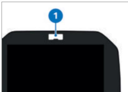
Der Schaltblitz **1** signalisiert dem Fahrer das Erreichen der zuvor eingestellten Drehzahlschwelle, bei der er in den nächsthöheren Gang schalten soll.
