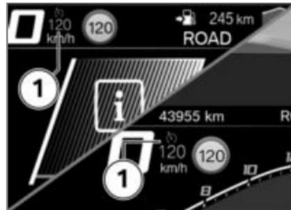
Il simbolo **1** del regolatore della velocità di marcia viene visualizzato nella schermata Pure Ride e nella riga di stato in alto.
