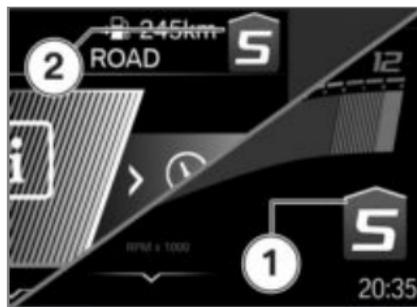
L'indicazione di cambiare marcia nella vista Pure Ride **1** o nella riga di stato **2** segnala il momento più conveniente per passare alla marcia superiore.
