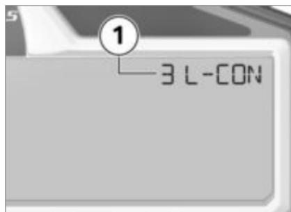
En la pantalla se muestran **L-CON** y la cantidad de arranques todavía admisible **1** con el Launchcontrol.
