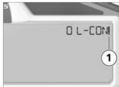
Si actualmente no es posible un arranque con el Launch-control, se mostrará la cantidad 0, completada con el signo de exclamación **1**.
