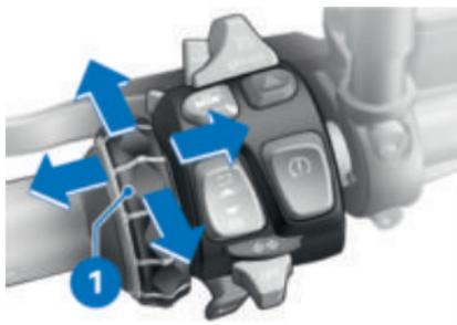
El manejo del sistema de navegación se realiza a través del Multi-Controller 1.
