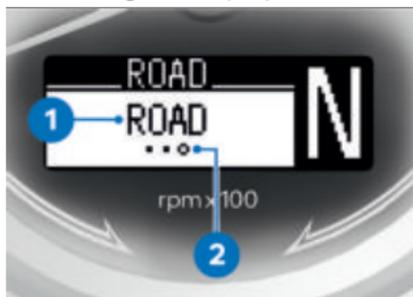
Der aktive Fahrmodus **1** wird angezeigt. Die Orientierungshilfe **2** zeigt an, wie viele Fahrmodi zur Verfügung stehen.◁
