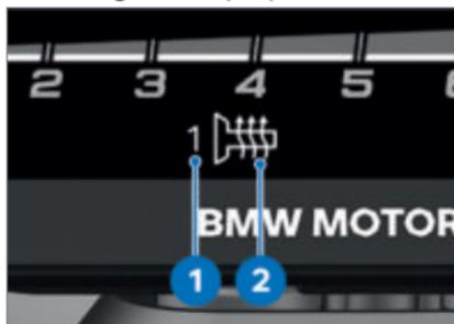
Die gewählte Heizstufe **1** und das Griffheizungs-Symbol **2** werden im Display angezeigt.◀
