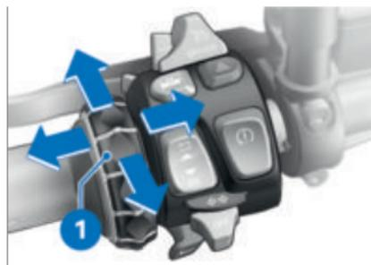
Die Bedienung des Navigationssystems erfolgt über den Multi-Controller **1**.
