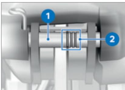
Zwischen den Bremsbelägen befindet sich die Achse **1** mit den drei Ringmarkierungen **2**.
