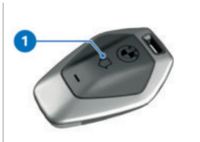
• Alternativ Taste **1** des Funkschlüssels einmal drücken.
