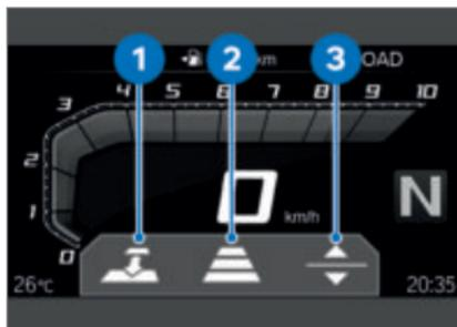
La respuesta del control muestra el icono de la correspondiente función **1** y del estado de la función **2**. Las flechas **3** indican las respectivas opciones de ajuste.
