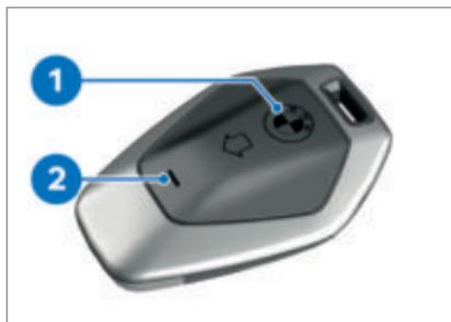
La tensión de la pila de la llave con mando a distancia se indica mediante el color del LED **2**.
