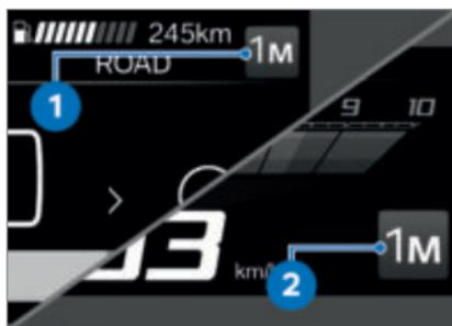
La marcha seleccionada por el conductor con indicador M para el modo manual se muestra en la barra de estado **1** o en la vista Pure Ride **2**.
