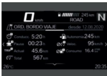
Los paneles de menú **ORDENADOR DE A BORDO** y **ORD. BORDO VIAJE** muestran los datos del vehículo y de la conducción; por ejemplo, los valores medios.
