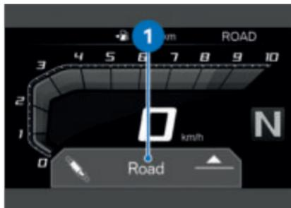
La amortiguación se puede ajustar en diferentes ajustes **1** en función del modo de conducción.
