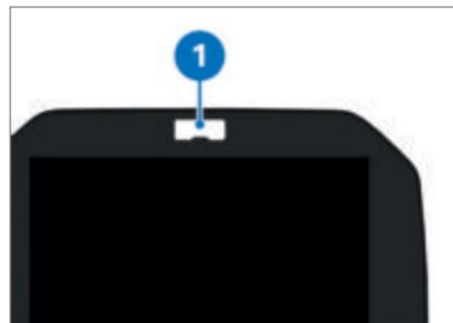
La luz de conexión **1** indica al conductor el régimen de revoluciones en el que tiene que cambiar a la siguiente marcha superior.
