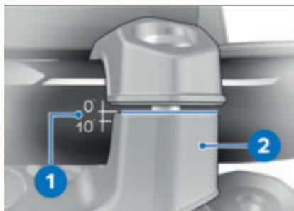
La inclinación del manillar puede ajustarse en los rangos de la marca **1**. Al hacerlo, alinear la marca **1** con el borde superior del puente del manillar **2**.
