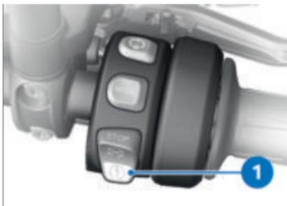
• Mantener presionada la tecla de arranque **1** hasta que arranque el motor.
