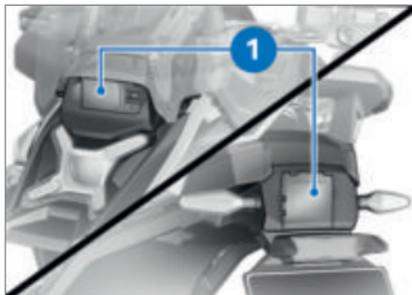
Limpiar las cubiertas **1** de los sensores de radar con un paño humedecido con limpiacristales.
