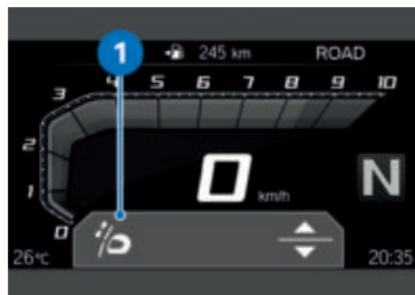
El ajuste del parabrisas **1** se realiza directamente pulsando una vez la tecla multifunción.
