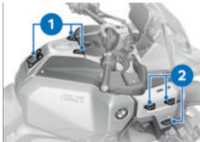
Los elementos de fijación adicionales en el depósito **1** y los embellecedores del radiador **2** ofrecen la posibilidad de colocar accesorios de BMW Motorrad como la mochila para el depósito y las bolsas del embellecedor del radiador.
