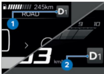
El indicador de modo automático D y de la marcha actual se muestra en la barra de estado **1** o en la vista Pure Ride **2**.
