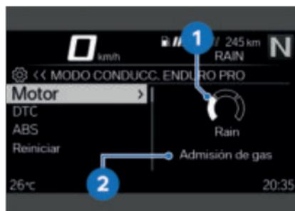
Se ha seleccionado el sistema Motor. El ajuste actual se muestra en forma de diagrama 1 con explicaciones del sistema 2.
