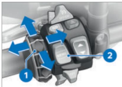
El manejo del sistema de navegación se realiza a través del Multi-Controller **1** y de la tecla basculante MENU **2**.
