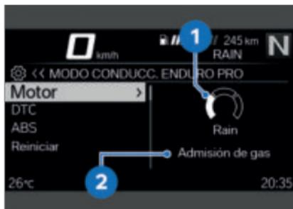
Se ha seleccionado el sistema Engine. El ajuste actual se muestra en forma de diagrama **1** con explicaciones del sistema **2**.
