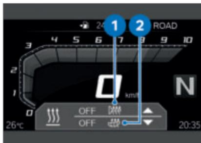
Los puños del manillar **1** y el asiento del conductor **2** tienen tres posiciones de calefacción. La potencia de calefacción alta sirve para realizar un calentamiento rápido; se recomienda volver a continuación a una potencia inferior.
