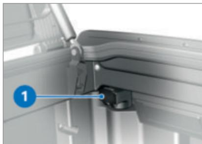
Se trata de una conexión de carga USB **1** de 5 V, que proporciona como máximo una corriente de carga de 3 A (máxima potencia de carga 15 W).
