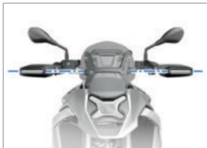
Los intermitentes no están alineados horizontalmente en perpendicular al eje longitudinal de la motocicleta:
