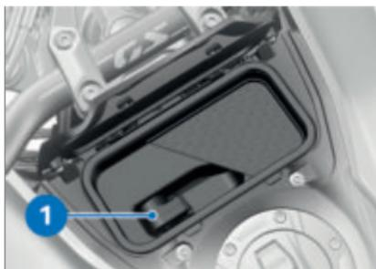
Se trata de una conexión de carga USB **1** de 5 V, que proporciona como máximo una corriente de carga de 2,1 A (máxima potencia de carga 10,5 W).
