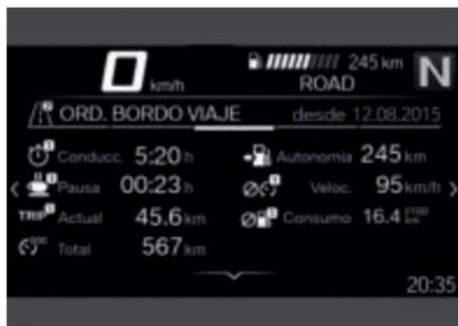
Los paneles de menú ORDENADOR DE A BORDO y ORDENADOR DE A BORDO VIAJE muestran los datos del vehículo y de la conducción; por ejemplo, los valores medios.
