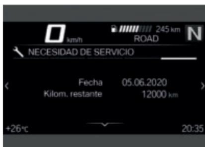
Si falta menos de un mes para el próximo servicio, o si el próximo servicio debe realizarse durante los próximos 1000 km, se muestra un mensaje Check-Control de color blanco.
