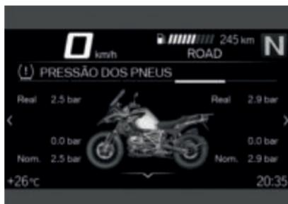
Os valores à esquerda se referem à roda dianteira; os valores à direita se referem à roda traseira.
