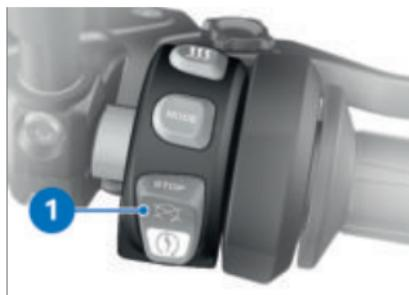
**1** Interruptor de desligamento de emergência
