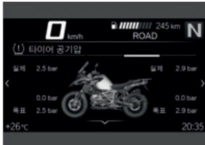
좌측 값은 전륜에 대한 것이고, 우측 값은 후륜에 해당합니다. 실제- 및 규정-타이어 공기압에 대한 공기압 차이가 표시됩니다. 점화 스위치 ON 직후에는 선만 표시됩니다. 타이어 공기압 값 전송은 다음 최저주행속도를 처음으로 초과한 후에만 실시됩니다:
