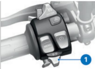
Wurde Taste **1** nach rechts oder links gedrückt, schalten die Blinker automatisch unter folgenden Bedingungen ab:
