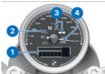
Im Display **1** werden alle Segmente angezeigt. Gleichzeitig werden alle Kontroll- und Warnleuchten **3** eingeschaltet.
