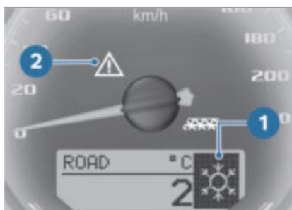
Warnungen, für die keine eigenständige Warnleuchte zur Verfügung steht, werden durch ein Warnsymbol **1** im Multifunktionsdisplay in Verbindung mit der allgemeinen Warnleuchte **2** dargestellt. Abhängig von der Dringlichkeit der Warnung leuchtet oder blinkt die allgemeine Warnleuchte.
