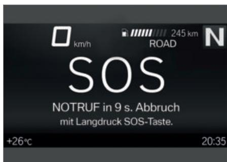
Die Zeit bis zum Absetzen des Notrufs wird angezeigt. Während dieser Zeit ist ein Abbruch des Notrufs durch langes Drücken der SOS-Taste möglich.
