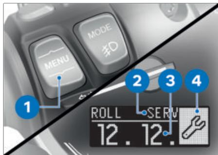
Ist der Service innerhalb eines Monats fällig, werden das Symbol für Service **4** und das Servicedatum **3** angezeigt. Die Anzeige **SERV 2** muss durch Betätigung der Taste **1** bestätigt werden.
