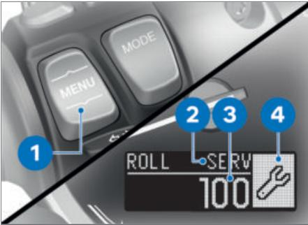
Ist der Service innerhalb von 1000 km fällig, werden das Symbol für Service **4** und die verbleibende Wegstrecke **3** angezeigt und in Schritten von 100 km heruntergezählt. Die Anzeige **SERV 2** muss durch Betätigung der Taste **1** bestätigt werden.
