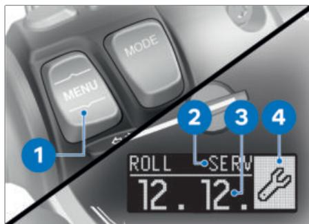
Ist der Service innerhalb eines Monats fällig, werden das Symbol für Service **4** und das Servicedatum **3** angezeigt. Die Anzeige **SERV 2** muss durch Betätigung der Taste **1** bestätigt werden.
