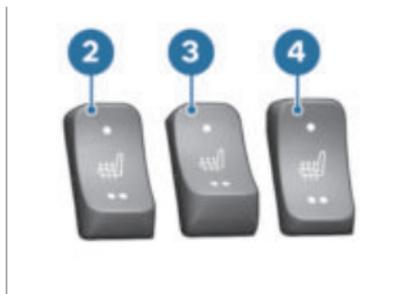
El asiento del acompañante puede calentarse en dos niveles. El segundo nivel sirve para calentar rápidamente el asiento; a continuación debe volverse al primer nivel.
