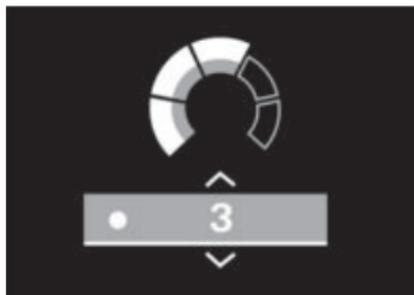
El asiento del conductor se puede calentar en cinco niveles. El quinto nivel sirve para calentar rápidamente el asiento; a continuación debe volverse a uno de los niveles inferiores.
