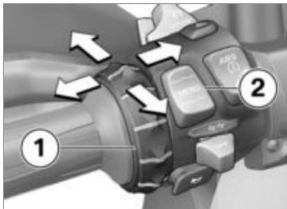
Die Bedienung aller Inhalte des Displays erfolgt über den Multi-Controller **1** und die Wipptaste MENU **2**.
