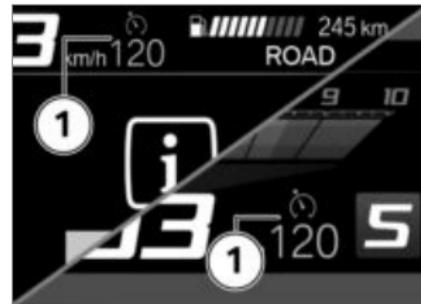
Das Symbol **1** für die Geschwindigkeitsregelung wird in der An-
