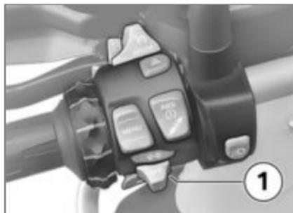
Wurde Taste **1** nach rechts oder links gedrückt, schalten die Blinker automatisch unter folgenden Bedingungen ab:
