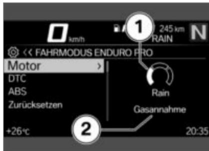
Das System **Motor** ist ausgewählt. Die aktuelle Einstellung wird als Diagramm **1** mit Erklärungen zum System **2** angezeigt.
