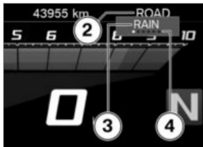
Der aktive Fahrmodus **2** rückt in den Hintergrund und der erste wählbare Fahrmodus **3** wird angezeigt. Die Orientierungshilfe **4** zeigt an, wie viele Fahrmodi zur Verfügung stehen.
