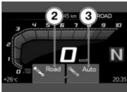
Sofort nach Betätigung der Taste **1** werden die Fahrwerkeinstellungen für Dämpfung **2**
