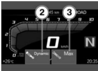
Die neuen Fahrwerkseinstellungen für Dämpfung **2** und Federvorspannung **3** werden für kurze Zeit angezeigt.
