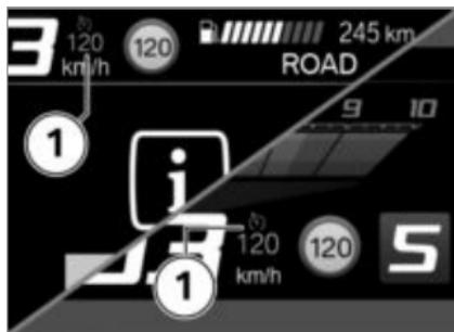
Das Symbol **1** für die Geschwindigkeitsregelung wird in der Ansicht Pure Ride und in der oberen Statuszeile angezeigt.
