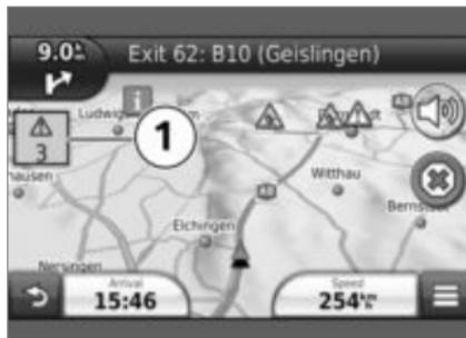
Kontroll- und Warnmeldungen des Motorrads werden mit einem entsprechenden Symbol **1** links oben auf der Kartenansicht angezeigt.
