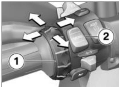
Die Bedienung des Navigationssystems erfolgt über den Multi-Controller **1** und die Wipptaste **MENU 2**.
