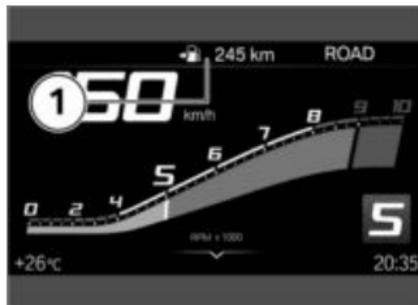
L'autonomia **1** indica quanta strada è possibile percorrere con il carburante rimanente. Il calcolo si effettua in base al consumo medio e alla quantità di carburante.
