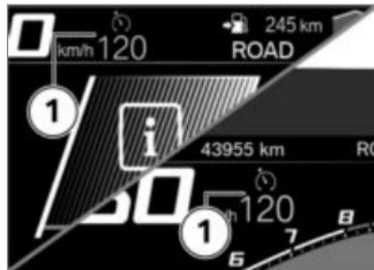
Il simbolo **1** del regolatore della velocità di marcia viene visualizzato nella schermata Pure Ride e nella riga di stato in alto.
