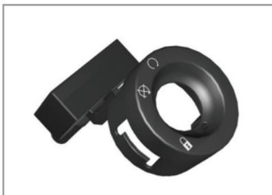
Pour vérifier l'autorisation de la clé de contact, le système d'immobilisation électronique échange des informations avec la clé de contact via l'antenne annulaire.
