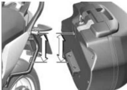
Si une valise est branlante ou ne peut être posée qu'avec difficulté, elle doit être adaptée au niveau de la distance entre la fixation supérieure et la fixation inférieure.
