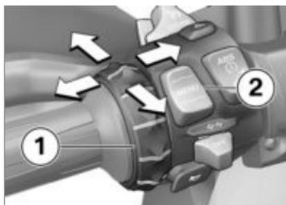
La commande du système de navigation s'effectue par l'intermédiaire du Multi-Controller **1** et de la touche basculante à retour MENU **2**.
