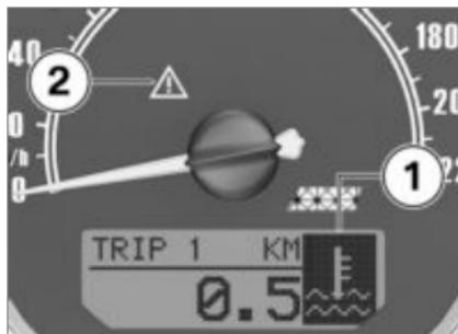
Warnungen, für die keine eigenständige Warnleuchte zur Verfügung steht, werden durch ein Warnsymbol **1** im Multifunktionsdisplay in Verbindung mit der allgemeinen Warnleuchte **2** dargestellt. Abhängig von der Dringlichkeit der Warnung leuchtet oder blinkt die allgemeine Warnleuchte.
