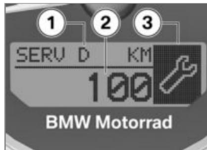
Ist der Service innerhalb von 1000 km fällig, werden das Symbol für Service **3** und die verbleibende Wegstrecke **2** angezeigt und in Schritten von 100 km heruntergezählt. Die Anzeige **SERV D 1** erfolgt für kurze Zeit im Anschluss an den Pre-Ride-Check.
