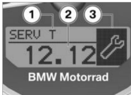
Ist der Service innerhalb eines Monats fällig, werden das Symbol für Service **3** und das Servicedatum **2** angezeigt. Die Anzeige **SERV T 1** erfolgt für kurze Zeit im Anschluss an den Pre-Ride-Check.
