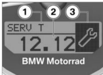
Si el servicio técnico vence dentro del plazo de un mes, se visualiza el símbolo del servicio técnico **3** y la fecha de servicio técnico **2**. La indicación **SERV T 1** se visualizará durante poco tiempo a continuación del Pre-Ride-Check.
