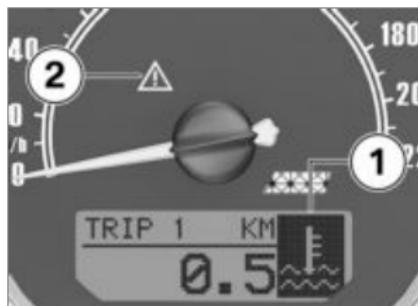
Los avisos para los que no se dispone de un testigo de aviso propio se indican mediante un símbolo de advertencia **1** en la pantalla multifunción en combinación con el testigo de aviso general **2**. En función de la urgencia de la advertencia, se ilumina o parpadea el testigo de aviso general.
