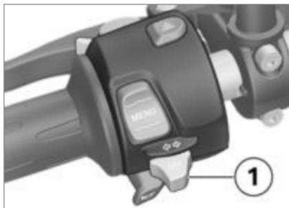
Si se ha pulsado la tecla **1** un rato más hacia la derecha o la izquierda, los intermitentes solo se apagan automáticamente una vez que se ha alcanzado el recorrido dependiente de la velocidad.
