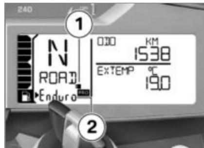
O símbolo para o conector de codificação **1** é exibido no display. Os modos de condução **2** Enduro PRO e DYNA PRO podem ser selecionados e substituem os modos de condução Enduro e DYNA.
