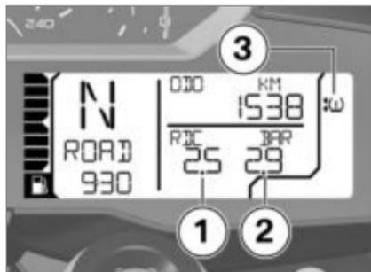
O valor esquerdo **1** indica a pressão da roda dianteira, o valor direito **2** indica a pressão da roda traseira. Imediatamente após ligar a ignição é exibido "-- --".
