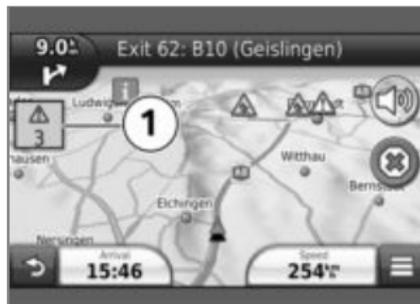
摩托车的指示和警告信息通过一个相应的图标 1 显示在地图视图的左上方。
