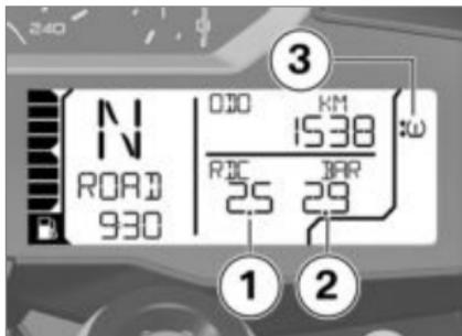
左侧数值 **1** 说明前轮的充气压力，右侧数值 **2** 说明后轮的充气压力。接通点火开关后立即显示“-- --”。当速度首次超过 30 km/h 后才开始传送轮胎压力值。所示轮胎充气压力均基于 20 °C 轮胎充气温度。
