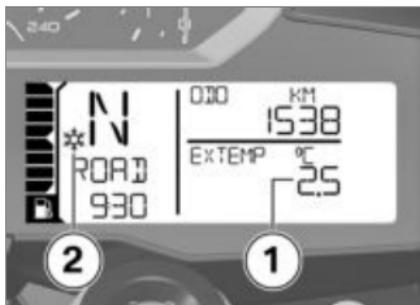
在外部温度低于 3 °C 时存在结冰的危险。一旦低于该温度，则无论显示屏设置如何，都会自动切换到外部温度显示 1 上，显示值闪烁。
