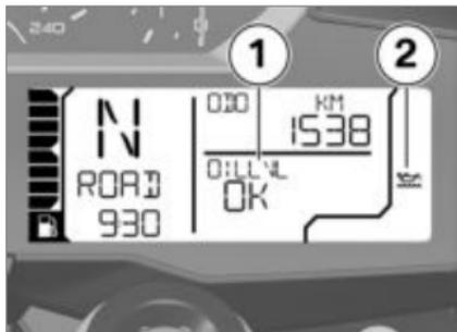
机油油位说明 1 提供关于发动机内机油油位的信息。它只能在车辆处于静止状态时调出。
