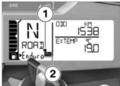
显示器中显示编码插接器图标 **1**。可以选择骑行模式 **2** Enduro PRO 和 DYNA PRO 并替换骑行模式 Enduro 和 DYNA。
