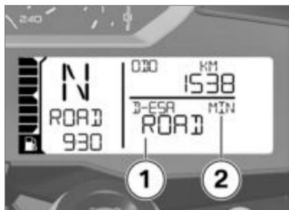
阻尼显示在多功能显示屏中的区域 **1** 内，弹簧预压力显示在区域 **2** 内。
