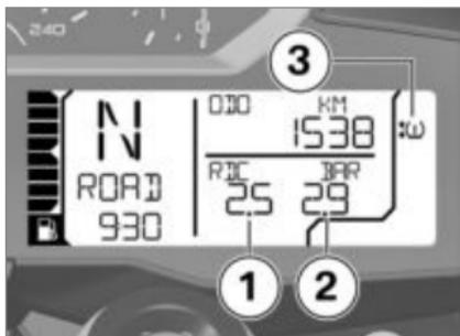
O valor à esquerda **1** indica a pressão da roda dianteira, o valor à direita **2** indica a pressão da roda traseira. Assim que se liga a ignição é apresentada a indicação "-- --". A transmissão dos valores de pressão dos pneus só tem início depois de ser excedida, pela primeira vez, a velocidade de 30 km/h. As pressões dos pneus indicadas referem-se a uma temperatura do ar do pneu de 20 °C.
