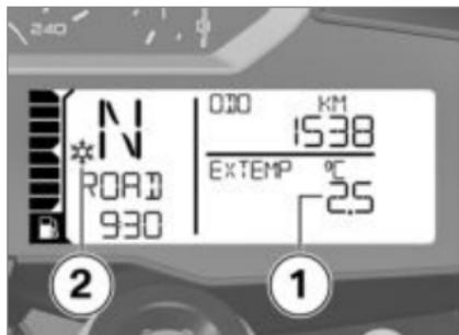
Caso sejam registadas temperaturas ambientes inferiores a 3 °C existe o perigo de formação de gelo. Quando a temperatura desce pela primeira vez abaixo deste valor, é automaticamente comutado para a indi-
