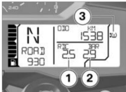
좌측 값 **1**은 전륜의 공기압이며, 우측 값 **2**는 후륜의 공기압입니다. 점화를 켜 직후 "-- --"가 표시됩니다. 타이어 공기압 값 전송은 주행속도 30 km/h를 처음으로 초과한 후에 시작됩니다. 표시된 타이어 공기압은 타이어 공기 온도 20 °C에 해당합니다.
