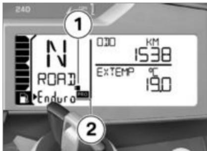
코딩 컨넥터용 기호 **1**이 디스플레이에 표시됩니다. 주행 모드 **2** Enduro PRO 및 DYNA PRO를 선택할 수 있고 주행 모드 Enduro 및 DYNA를 대체합니다.
