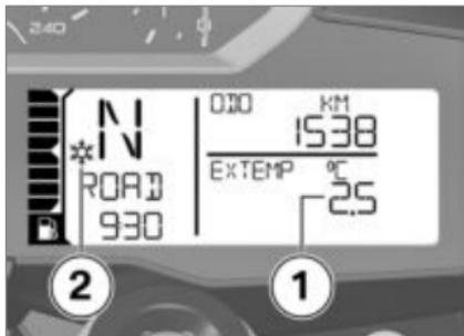
In caso di temperature esterne sotto ai 3 °C esiste il pericolo della formazione di ghiaccio. La prima volta che si raggiungono valori inferiori a questa temperatura indipendentemente dall'impostazione del display si passa automaticamente all'indicazione
