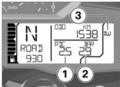
Il valore di sinistra **1** indica la pressione di gonfiaggio della ruota anteriore, il valore di destra **2** la pressione di gonfiaggio della ruota posteriore. Subito dopo l'accensione del quadro viene visualizzato "- -". La trasmissione delle pressioni degli pneumatici inizia solo dopo aver superato per la prima volta una velocità di 30 km/h. Le pressioni di gonfiaggio visualizzate si riferi-
