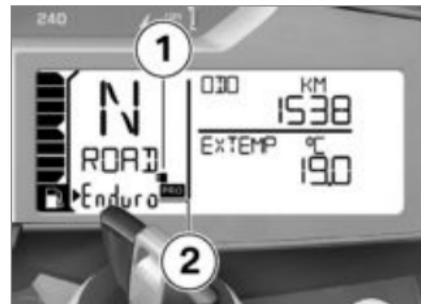
Nel display viene visualizzato il simbolo del connettore codificato **1**. Sono selezionabili le modalità di marcia **2** Enduro PRO e DYNA PRO, che sostituiscono le modalità di marcia Enduro e DYNA.
