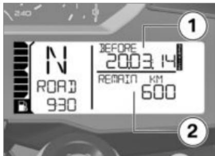
Si falta menos de un mes para el próximo servicio técnico o este se debe realizar dentro de 1000 km, se mostrarán brevemente la fecha del servicio técnico **1** y los kilómetros restantes **2** inmediatamente después del Pre-Ride-Check.
