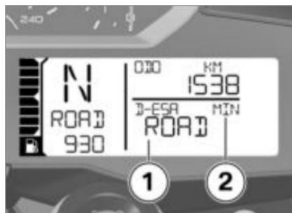
La amortiguación se indica en la pantalla multifunción, en la zona **1**, y el pretensado de los muelles, en la zona **2**.
