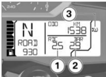
La valeur de gauche **1** indique la pression de gonflage de la roue avant, la valeur de droite **2** la pression de gonflage de la roue arrière. Dès que l'on met le contact, « -- -- » s'affiche. La transmission des valeurs de pression des pneus ne commence que lorsqu'une vitesse de 30 km/h a été dépassée pour la première fois. Les pressions de gonflage des pneus affichées se réfèrent à une température de pneu de 20 °C.
