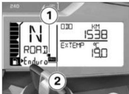
Le symbole **1** du connecteur de codage est affiché à l'écran. Les modes de conduite **2** Enduro PRO et DYNA PRO peuvent être sélectionnés et remplacent les modes de conduite Enduro et DYNA.
