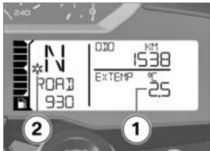
Le risque de verglas existe lorsque la température extérieure descend sous 3 °C. Lorsque la température descend pour la première fois en dessous de cette valeur, l'écran commute automatiquement sur l'affichage de température **1** quel que soit
