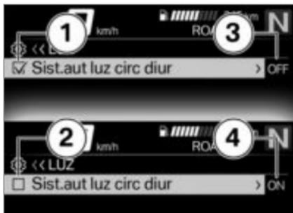
Alguns itens do menu são precedidos de uma caixa de seleção. A caixa de seleção indica se a função está ligada ou desligada. Símbolos de ação à frente dos itens de menu indicam o que é possível navegar para a direita inclinando brevemente o Multi-Controller.
