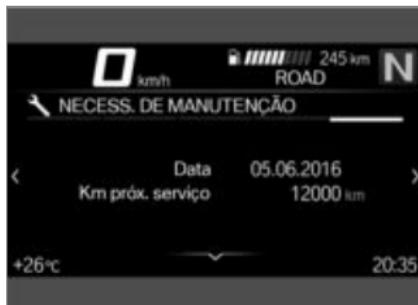
Se o tempo que falta para o próximo serviço for inferior a um mês, ou se o próximo serviço for necessário em menos de 1000 km, será exibida uma mensagem do Check Control branca.
