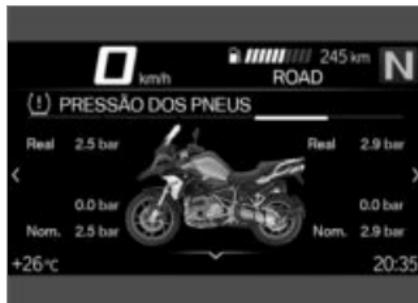
Os valores à esquerda dizem respeito à roda dianteira; os valores à direita dizem respeito à roda traseira.
