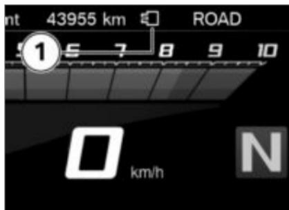
O símbolo para o conector de codificação **1** é exibido. Os modos de condução **ENDURO PRO** e **DYNAMIC PRO** podem ser selecionados e substituem os modos de condução **ENDURO** e **DYNAMIC**.
