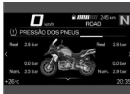
Os valores à esquerda referem-se à roda dianteira, os valores à direita à roda traseira.
