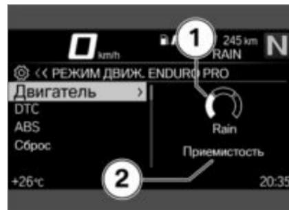
Система Двигатель выбрана. Текущая настройка отображается в виде схемы 1 с пояснениями к системе 2.
