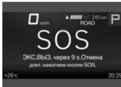
Отображается время до совершения экстренного вызова. В течение этого времени экстренный вызов можно отменить.
