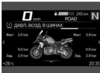
Значения слева указаны для переднего колеса, значения справа — для заднего. При помощи реального и фактического давления воздуха в шинах отображается разность давлений. Сразу после включения зажигания показываются только штрихи. Передача значений давления в шинах начинается
