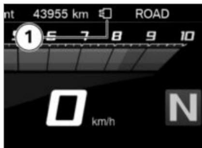
Отображается символ кодировочного разъема **1**. Режимы движения ENDURO PRO и DYNAMIC PRO можно выбирать, при этом они заменяют режимы движения ENDURO и DYNAMIC.
