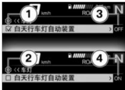
一些菜单选项前面有小方框。小方框显示功能是否打开或关闭。菜单选项后面的操作图标形象的说明，通过短按多功能控制器可向右切换。
