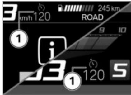
定速控制的图标 **1** 将在视图 Pure Ride 和上部状态栏中显示。
