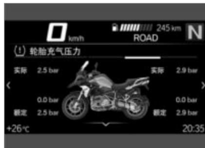
左侧值关联前轮，右侧值关联后轮。
