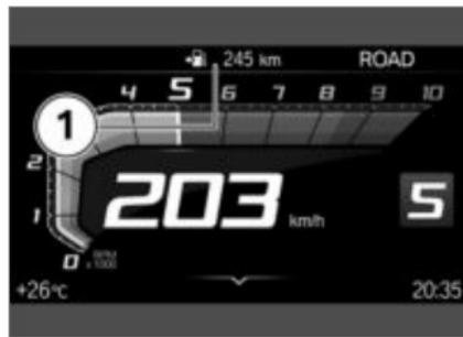
续航里程 **1** 说明，使用剩余燃油还能骑行的里程。计算根据平均油耗和燃油量进行。
