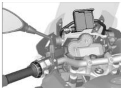
Consiste de suporte para o sistema de navegação, Advanced Mount Cradle com cilindro de fecho e Multi-Controller para operação do navegador BMW Motorrad no guidão, entre outros elementos.
