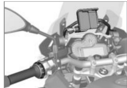
Αποτελείται μεταξύ άλλων από βάση για σύστημα πλοήγησης, Advanced Mount Cradle με βαρελάκι κλειδαριάς και Multi-Controller για τον χειρισμό του BMW Motorrad Navigator στο τιμόνι.
