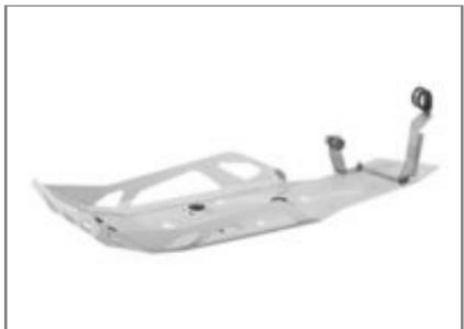
Защищает нижнюю область двигателя от ударов камнями и выступающих предметов. Значительно шире и длиннее, чем серийная защита двигателя.
