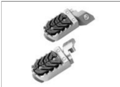
Repose-pieds forgés de grande qualité, couleur or anodisé, réglable en hauteur sur 3 niveaux. Marchepied suspendu pour une suspension confortable pendant la conduite en position assise. En conduite en position debout, le marchepied s'abaisse complètement du fait du poids supplémentaire. Le contour extérieur dentelé qui apparaît offre un maintien encore amélioré et par conséquent un meilleur contrôle du véhicule.
