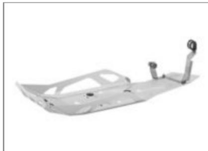
Protège le bas du moteur des gravillons et des coups au talonnement de la moto. Nettement plus large et plus long que le pare-moteur de série.
