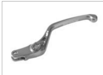
Manetes de embraiagem e de travão de mão em alumínio anodizado cinzento fresado por CNC, para proteger contra a corrosão. A distância entre o punho do guidador e a manete pode ser ajustada consoante a preferência pessoal.
