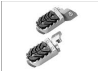
Высококачественные кованые упоры для ног, с золотистым анодированием, трехуровневая регулировка высоты. Подпружиненная накладка для комфортной амортизации при езде в сидячем положении. При движении стоя накладка полностью амортизирует нагрузку за счет дополнительного веса. Выступающий в результате этого зазубренный внешний контур обеспечивает еще более оптимальную фиксацию
