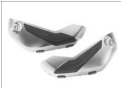
Полная защита крышки головки блока цилиндров от царапин и ударов камней. Сменная внешняя пластмассовая защита от истирания.
