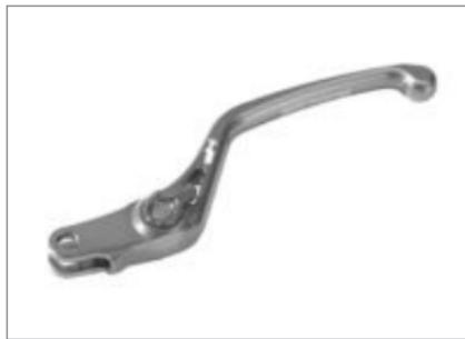
Фрезерованный рычаг сцепления и тормоза из высокопрочного алюминиевого сплава, с серым анодированием для защиты от коррозии.
