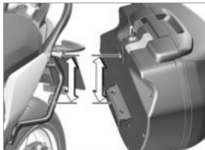
Se uma mala balançar ou se for muito difícil de instalar, ela deverá ser adaptada à distância entre o apoio superior e inferior.
