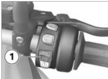
1 Interruptor de desligamento de emergência
