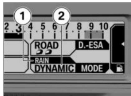
El ajuste actual se muestra en la posición **2**. Cada vez que se pulsa una tecla, en la posición **1** aparece uno de los modos de conducción posibles.
