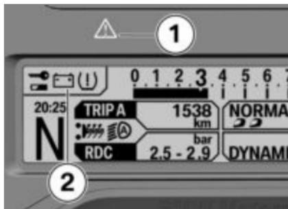
Los avisos para los que no hay ningún testigo de aviso propio se representan con testigos de aviso generales **1** con hasta tres símbolos de advertencia en la posición **2** que aparecen de derecha a izquierda. Se muestran por prioridad. La máxima prioridad está a la derecha. En fun-
