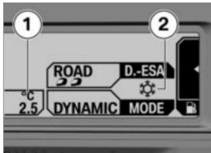
Si la temperatura exterior desciende por debajo del margen límite, se muestra una advertencia de posible formación de placas de hielo. En el momento en el que esta temperatura no se supera, independientemente del ajuste de la pantalla, se cambia automáticamente al indicador de temperatura **1** y el valor visualizado parpadea.
