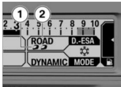
El pretensado de los muelles se indica en la pantalla multifunción, en la zona **1**, y la amortiguación, en la zona **2**.
