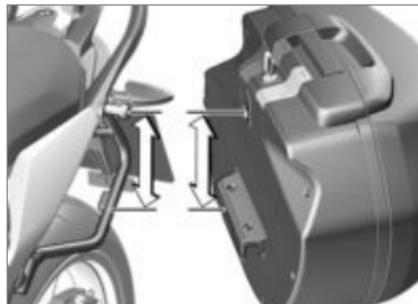
Si une valise est branlante ou ne peut être posée qu'avec difficulté, elle doit être adaptée au niveau de la distance entre la fixation supérieure et la fixation inférieure.
