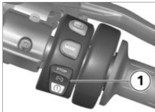
1 Interruptor de parada de emergencia
