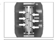
Limite de desgaste das pastilhas do freio dianteiro
