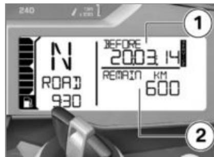
Se il tempo rimanente per il service successivo è inferiore a un mese oppure se il service successivo scade entro 1000 km, la data del service **1** ed i chilometri rimanenti **2** vengono visualizzati brevemente dopo il Pre-Ride-Check.
