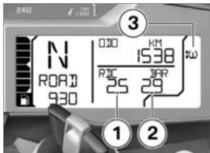
Il valore di sinistra **1** indica la pressione di gonfiaggio della ruota anteriore, il valore di destra **2** la pressione di gonfiaggio della ruota posteriore. Subito dopo l'inserimento dell'accensione viene visualizzato "-- --". La trasmissione dei valori della pressione pneumatici inizia dopo aver superato una prima volta la velocità di 30 km/h. Le pressioni di gonfiaggio visualizzate si riferiscono a una temperatura dell'aria interna dei pneumatici di 20 °C.
