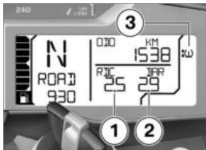
El valor de la izquierda **1** representa la presión de inflado de la rueda delantera, y el de la derecha **2**, el de la rueda trasera. Inmediatamente después de conectar el encendido aparece "-- --". La transmisión de los valores de presión de inflado comienza una vez superada por primera vez una velocidad de 30 km/h. Las presiones de inflado de los neumáticos indicadas hacen referencia a una temperatura del aire de los neumáticos de 20 °C.
