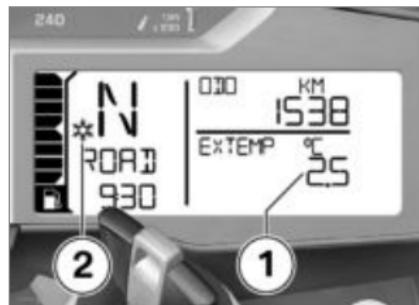
Le risque de verglas existe lorsque la température extérieure descend sous 3 °C. Lorsque la température descend pour la première fois en dessous de cette valeur, l'écran commute automatiquement sur l'affichage de température **1** quel que soit le réglage et la valeur affichée clignote.
