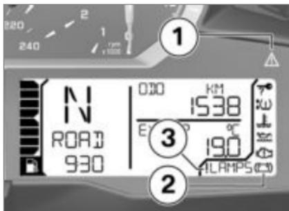
Warnungen, für die keine eigenständige Warnleuchte zur Verfügung steht, werden durch die allgemeine Warnleuchte **1** in Verbindung mit einem Warnsymbol im Bereich **2** oder mit einem Warnhinweis im Bereich **3** dargestellt. Abhängig von der Dringlichkeit der Warnung leuchtet
