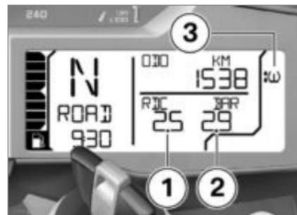
Der linke Wert **1** gibt den Fülldruck des Vorderrads an, der rechte Wert **2** den Fülldruck des Hinterrads. Unmittelbar nach Einschalten der Zündung wird "-- --" angezeigt. Die Übertragung der Reifendruckwerte beginnt erst nach dem erstmaligen Über-
