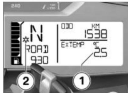
Bei Außentemperaturen unter 3 °C besteht die Gefahr von Glatteisbildung. Beim erstmaligen Unterschreiten dieser Temperatur wird unabhängig von der Displayeinstellung automatisch auf die Außentemperaturanzeige **1** umgeschaltet, der angezeigte Wert blinkt.
